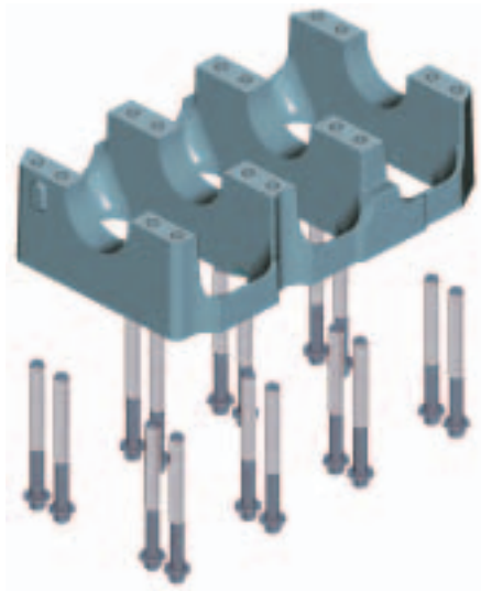
Unión atornillada / conjunto integral de cojinetes de bancada
