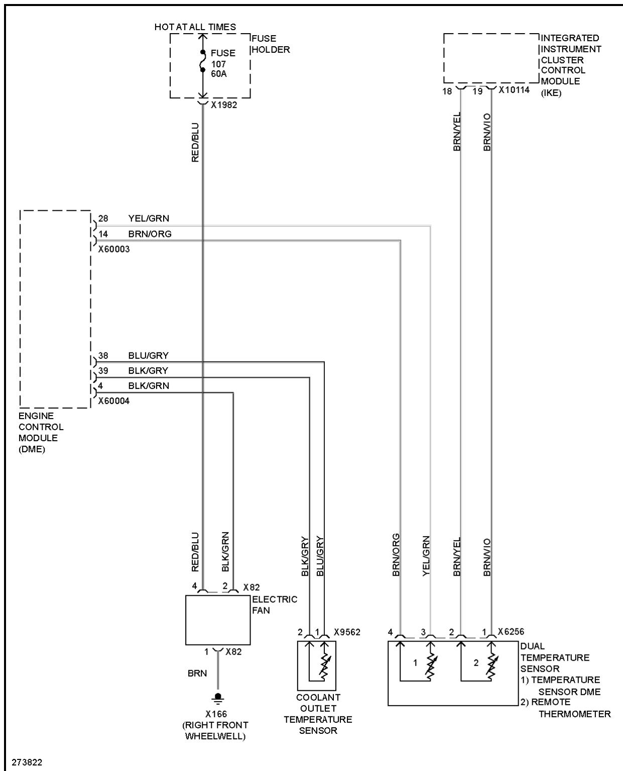
**Fig. 21: 4.8L, Cooling Fan Circuit**
