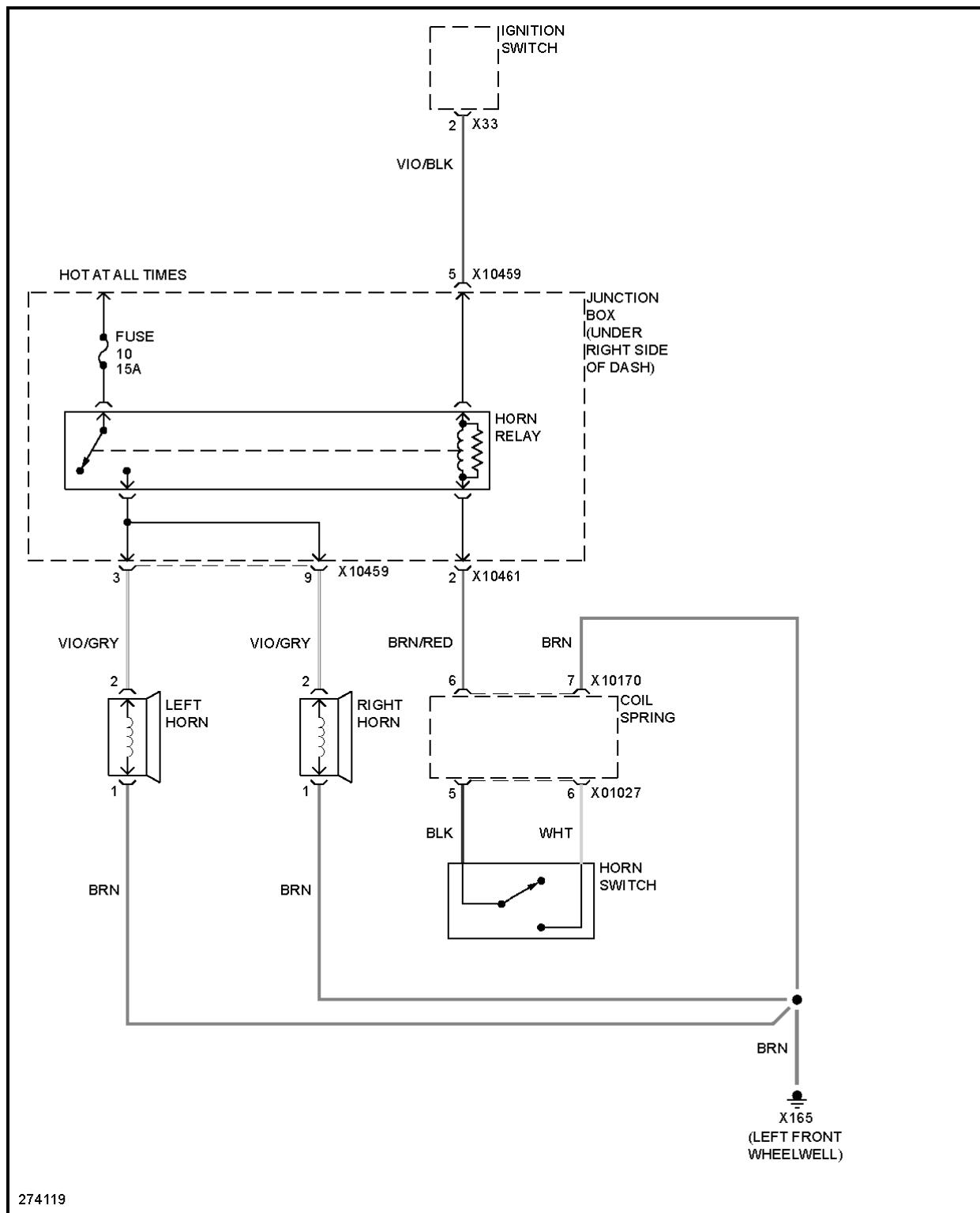
**Fig. 61: Horn Circuit**
