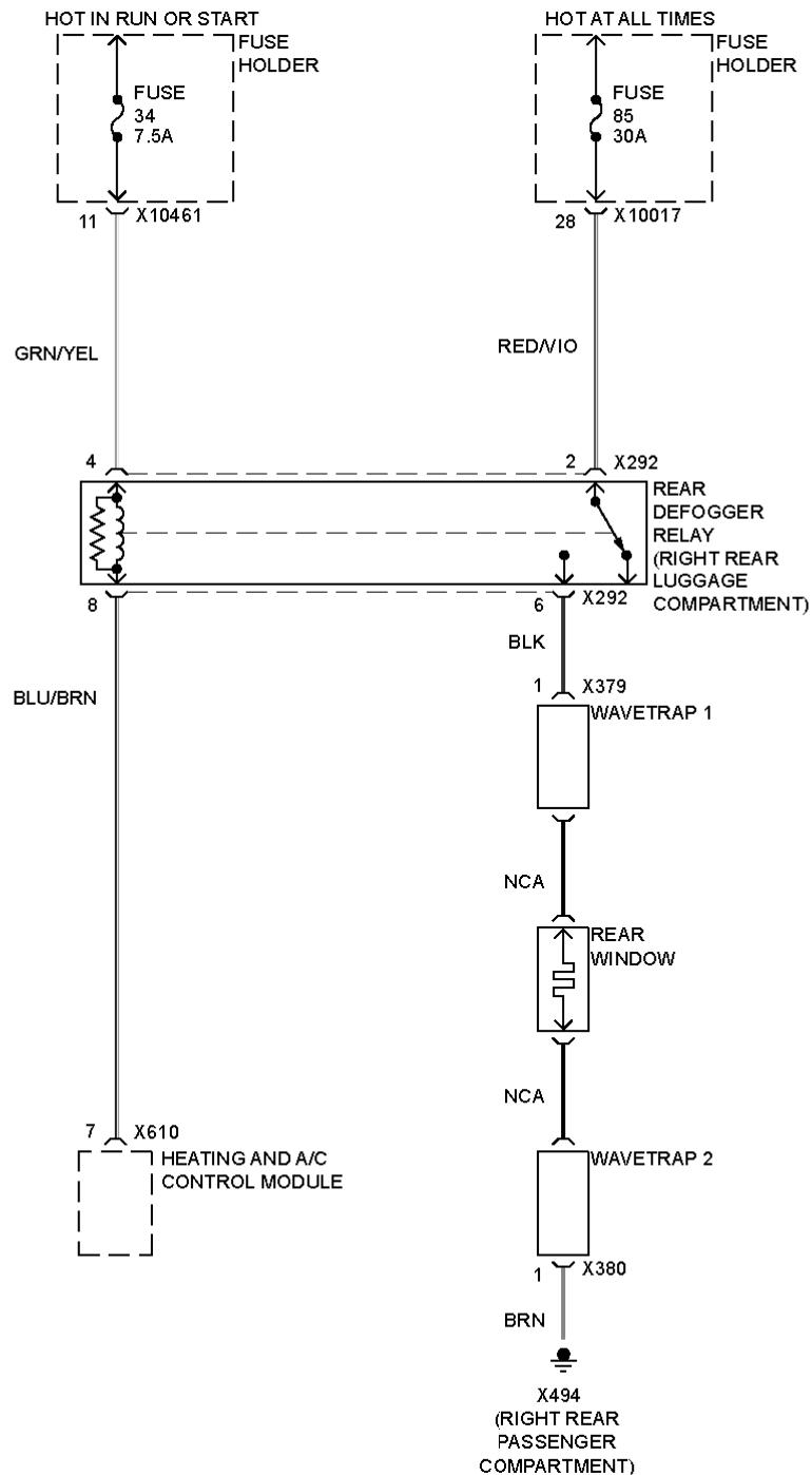
**Fig. 25: Rear Defogger Circuit**
