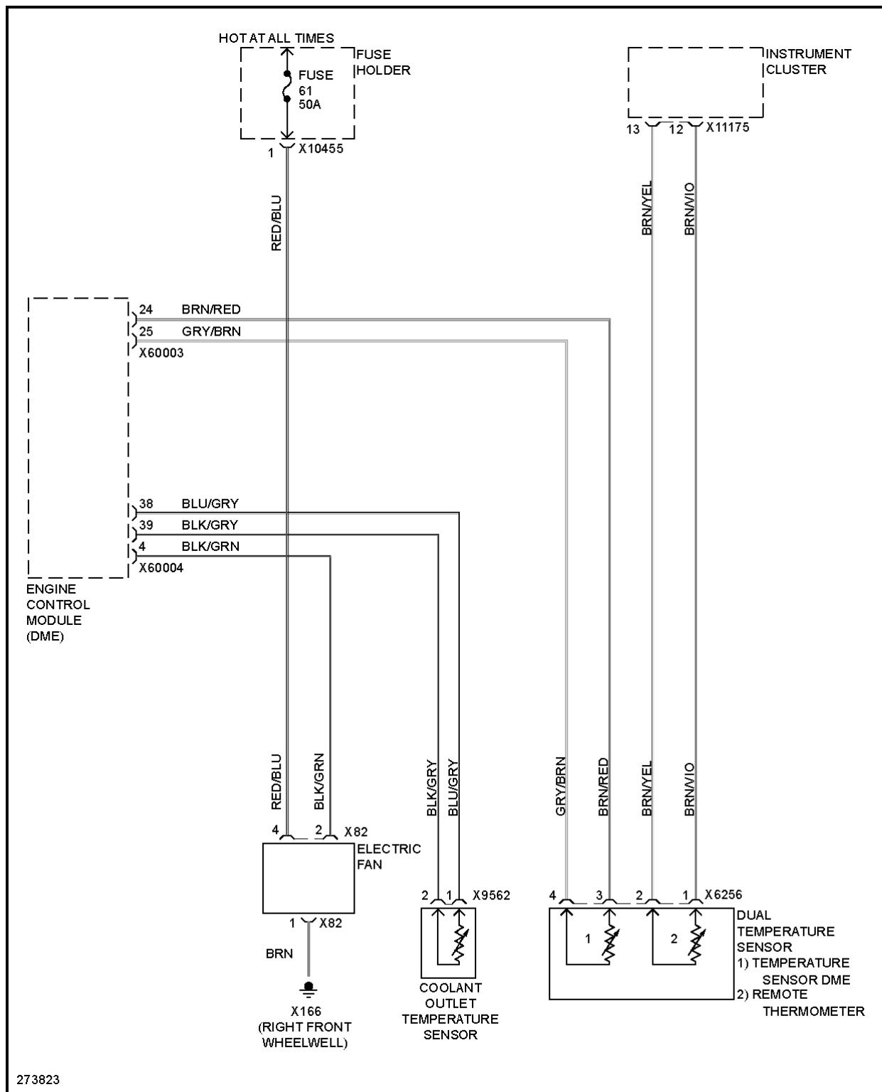
**Fig. 19: 3.0L, Cooling Fan Circuit**
