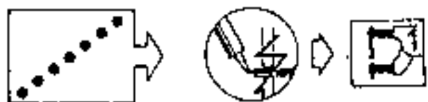
(A) 2 puntos en 3 espesores.
