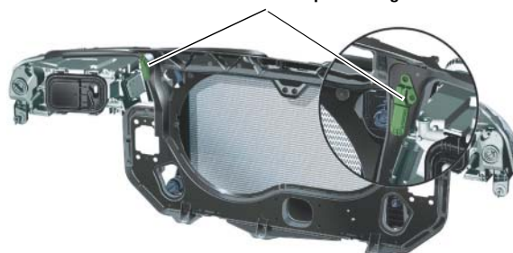
Sensores de colisión para airbag delantero
