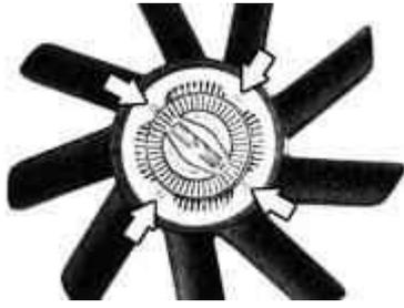
3 Retire el impulsor del acoplamiento viscoso quitando los tornillos (flechas en la ilustración) y tirando del embrague.
