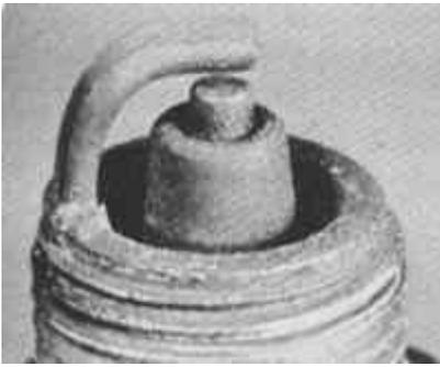
**Síntomas:** la presencia de hollín indica un nuevo enriquecimiento de la mezcla de combustible y aire o una intensidad débil de la chispa. Causa fallas de encendido, dificulta el arranque y conduce a la inestabilidad del motor.
