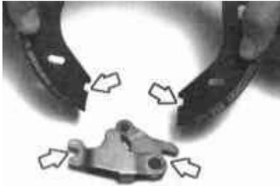
5 Vuelva a instalar las pastillas de freno. Por encima de las pastillas de freno debe entrar en las ranuras (flechas en la ilustración) de la cerradura.
