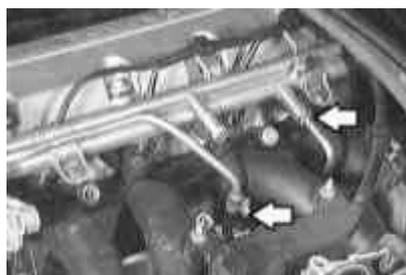
3 Limpie las líneas de combustible. Luego retire la alimentación y regrese la tubería.
