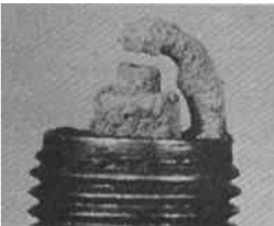
**Síntomas:** depósitos de color marrón suave en una o ambas velas del electrodo. La fuente de su formación son los aditivos aplicados al aceite y / o combustible. La acumulación excesiva puede conducir al aislamiento de los electrodos y provocar un funcionamiento incorrecto e inestable del motor durante la aceleración.
