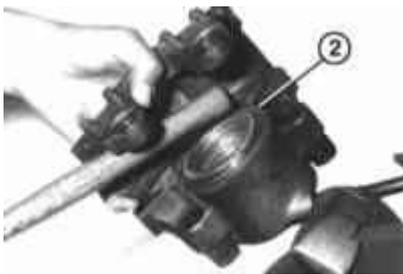
12 Verifique que la tapa contra el polvo -2- no tenga grietas. En presencia de daños, la tapa debe ser reemplazada inmediatamente, ya que la contaminación penetrada rápidamente conduce a la pérdida de la rigidez de la pinza. Para hacer esto, quite la pinza y desmonte (trabaje SRT).
