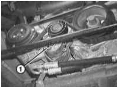
3 **Versión con elemento tensor mecánico:** Libere el elemento tensor por hexágono -1- en el sentido de las agujas del reloj. Retire la correa trapezoidal.
