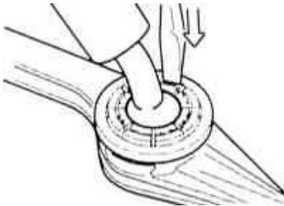
8 Empuje el inserto desde la parte superior con un destornillador en el soporte para que las lengüetas estén firmemente bloqueadas.
