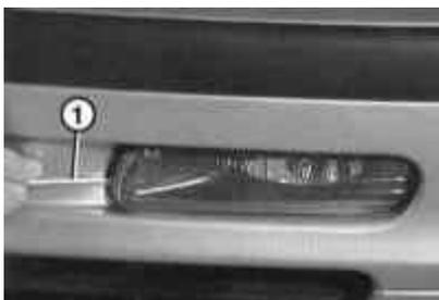
19 Retire la lámpara de niebla -1 del costado del cuerpo con un destornillador pequeño.
