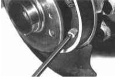
3 Apriete ligeramente el resorte con una llave de tubo de 5 mm, gírelo 90 ° (1/4 de vuelta) y retire el muelle de la zapata de freno.
