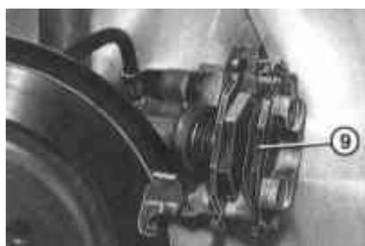
19 Inserte la zapata exterior -9- en la pinza y coloque la pinza en la guía. Asegúrese de que las almohadillas estén limpias.
