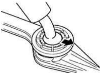
7 Instale la palanca de cambios con la inserción esférica de manera que las flechas en la inserción se muestren en la dirección del eje longitudinal del vehículo (flecha en la ilustración adjunta). Los pies del revestimiento esférico se encuentran en el interior del automóvil.
