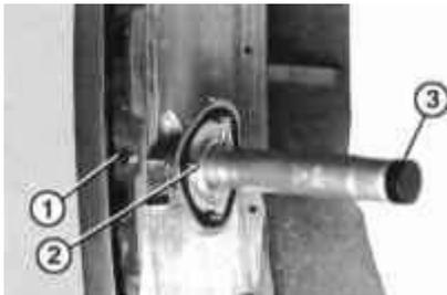
2 Desenrosque los pernos -1 del montaje y retire el amortiguador. 3 - cubierta.
