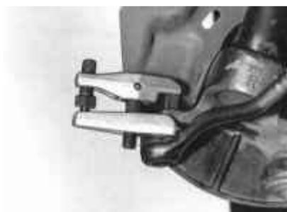
5 Retire el extremo de la barra de acoplamiento con la herramienta HAZET779 -1.
