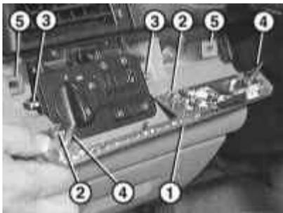
Instale la visera -1- para que entre en las guías -2- en las clavijas -3- y las clavijas -4- en las abrazaderas -5-. Presione fuertemente la visera, si es necesario, golpee cuidadosamente las palmas.
