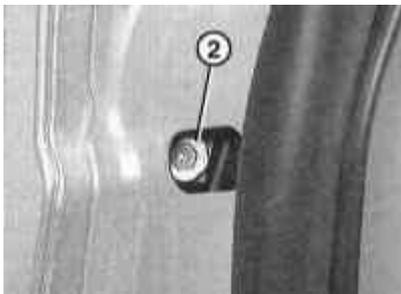
2 Retire el tornillo -2- con una llave de tubo de 5 mm a través del orificio en la hoja de la puerta. Al mismo tiempo, presione el tornillo hacia adentro para que no se caiga.
