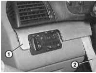
Retire la visera delantera izquierda -1- del panel de instrumentos. Para eliminarlo, puede usar una cuña de plástico -2-, por ejemplo, HAZET 1965-20.
