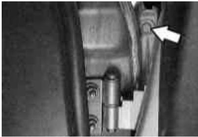
10 Abra la puerta y, a través de la ranura, desatornille el perno de fijación (flecha en la ilustración) en el pilar A.
