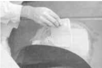
6 Trabajando rápidamente para evitar la masilla de masilla, use un aplicador de plástico con presión para aplicarlo a la superficie del metal, asegurándose de que haya un acoplamiento completo con el metal. Trate la masilla de modo que tome una forma cercana a la forma original del área y ligeramente elevada sobre la superficie circundante.
