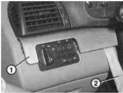
Retire la visera delantera izquierda -1- del panel de instrumentos. Para eliminarlo, puede usar una cuña de plástico -2-, por ejemplo, HAZET 1965-20.
