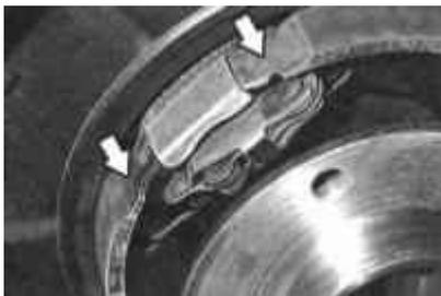
5 Desconecte ambas pastillas de freno en la parte superior y levante hacia abajo.
