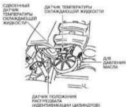
8 Sensor de temperatura del refrigerante del motor (ECT): según la información del sensor, el ECM / PCM realiza los ajustes necesarios en la composición de la mezcla de aire y combustible y la sincronización del encendido, y también controla el funcionamiento del sistema de EGR.
