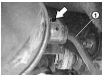
4 Retire la barra estabilizadora -1- de la viga del eje trasero (flecha en la ilustración) y tire de ella hacia abajo. Nota: La ilustración muestra solo la fijación a la izquierda.
