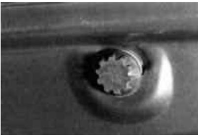
16 Desatornille el tope para que la campana esté bajo tensión. Para hacer esto, molde de dos barras de plastilina con una altura de aproximadamente 10 mm. Coloque las barras en las paradas y cierre la capucha. Abra la capucha y mida la altura de la parada y la columna comprimida. Desactive las paradas por el tamaño del tamaño recibido + 0,5 mm. De esta forma, ajuste todas las paradas.
