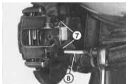
20 Compruebe visualmente los dos pernos que sujetan la pinza, si es necesario, limpie la abrazadera de suciedad. Si es necesario, enrosque el soporte con un toque. Pernos que tienen daño por oxidación o rosca, reemplace. Asegure los tornillos -7- con la llave de tubo -8- por 7 mm con un par de 30 N • m.
