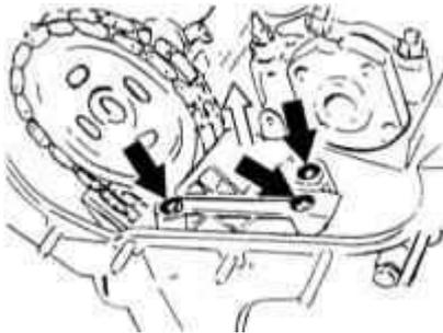
59 Retire los pernos y retire la pinza de la cadena de distribución (flechas en la ilustración).
