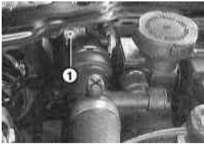
6 Retire el tornillo -1- de la esquina superior izquierda del radiador.
