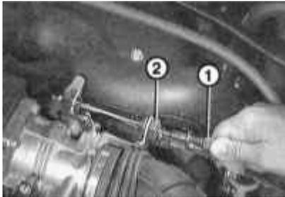
5 Retire la carcasa con el tornillo de ajuste -1- hacia atrás desde el buje de goma -2- en el soporte. Retire la manga de goma del soporte lateralmente.
