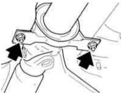
10 Retire los pernos y retire el cojinete central del árbol de propulsión (flechas en la ilustración). Sostenga el eje para que no se caiga.
