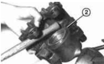
5 Verifique que la tapa protectora contra el pistón del freno -2- no presente grietas. Si hay grietas, reemplace la tapa inmediatamente, ya que la contaminación rápidamente lleva a la pérdida del sello de la pinza. Para esto, la pinza debe ser removida y desmontada (operación de la estación de servicio).
