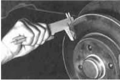
Mida el grosor del disco 2. SRT utiliza para este calibre especial o un micrómetro, debido a que la cuenta de desgaste se forma durante el disco. El grosor del disco se puede medir usando un calibre convencional. A esto hay que poner en cada lado de la almohadilla de disco de un cierto espesor (por ejemplo, dos monedas). Luego, a partir de los valores de medición resultantes es necesario restar el grosor de dos monedas. Nota: La medición es necesario hacer algunas observaciones.
