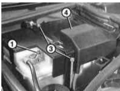
6 **Modelos 316i, 318i:** Retire los pernos de montaje -3- y retire la abrazadera. Retire la cubierta positiva del terminal -4- y la tapa de la batería. 1 - cable negativo.
