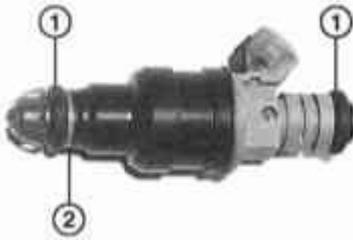
16 Inserte los inyectores en el colector de distribución de combustible y asegúrelos con abrazaderas.
