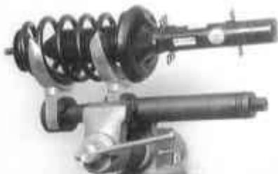
2 Para quitar el amortiguador, es necesario comprimir el resorte. El resorte es comprimido por medio de dispositivos, por ejemplo, HAZET 4900. Dicho dispositivo debe estar sujeta en un tornillo de banco, como se ilustra. Para proteger la superficie del resorte, es necesario usar forros de plástico HAZET.
