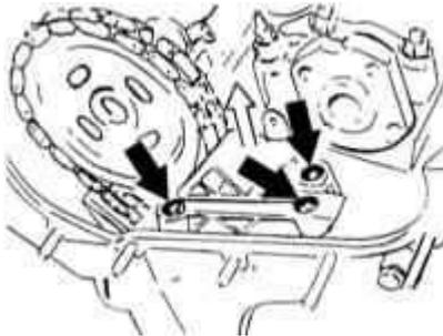
70 Asegure el estabilizador de cadena con los pernos.
