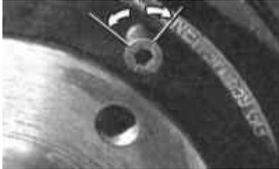
6 Apriete los dos resortes de compresión con una llave de tubo de 5 mm y gírelos simultáneamente 90 °. En la posición cerrada, la marca en la cabeza del tornillo es como se muestra en la ilustración.
