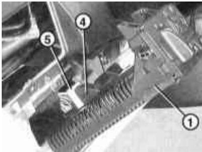
4 Deshaga el conector -4- y retírelo del interruptor -1-. Para hacer esto, desconecte el yugo -5- y retírelo del cable.
