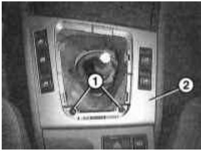
2 Retire los tornillos -1-. 2 - una visera de la palanca de un cambio de marcha.
