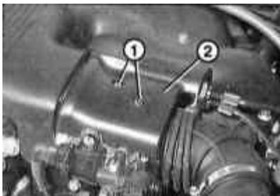
1 **Modelos 316i, 318i:** Retire los tornillos de montaje -1- del elemento del acelerador y retire la tapa -2-.
