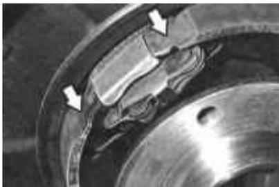
8 Las pastillas de freno (flechas en la ilustración) deben estar adyacentes al soporte de la pinza de freno.
