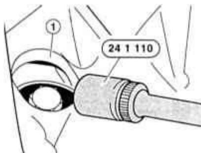
44 Retire el clip del cárter y atornille los tres pernos de montaje del convertidor de torque en los orificios de la caja. Apriete los pernos a 45 N • m. Use solo pernos originales.
