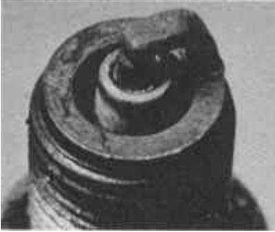
**Síntomas:** el aislador tiene un color amarillento y una apariencia pulida. Habla de un aumento repentino de la temperatura en las cámaras de combustión durante una aceleración repentina. Los depósitos habituales se derriten y se convierten en una especie de revestimiento de barniz. Produce humos de ignición a altas velocidades.
