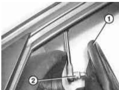
4 Retire el tornillo de dirección superior -1- con un destornillador Torx T30-2. Para abrir el tornillo, puede usar la tecla de esquina final. Gire el volante 180 ° (1/2 vuelta) y desenrosque completamente el segundo tornillo de fijación del airbag. Los tornillos permanecen en el volante.
