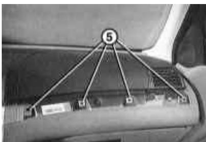
2 Vuelva a colocar la visera delantera para que entre en las clavijas en los clips -5-. Presione fuertemente la visera, si es necesario, golpee cuidadosamente las palmas.
